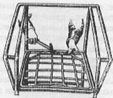
Рис. 56. Установка внутренней рамки сидения с сеткой в основную рамку кресла
